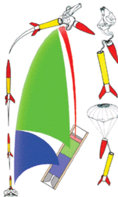
Les différents blocs de propergol du micropropulseur sont chacun associés à une partie caractéristique du vol de la fusée
